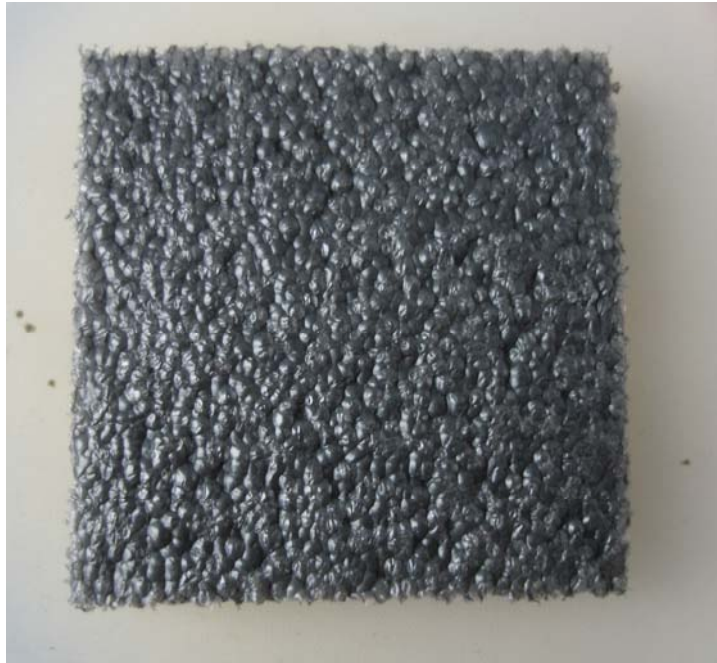
Foto 1: Untersuchungsmaterial HR ISO Rohrsystem nach einer Inkubationszeit von 28 Tagen ohne sichtbaren Pilzbewuchs
