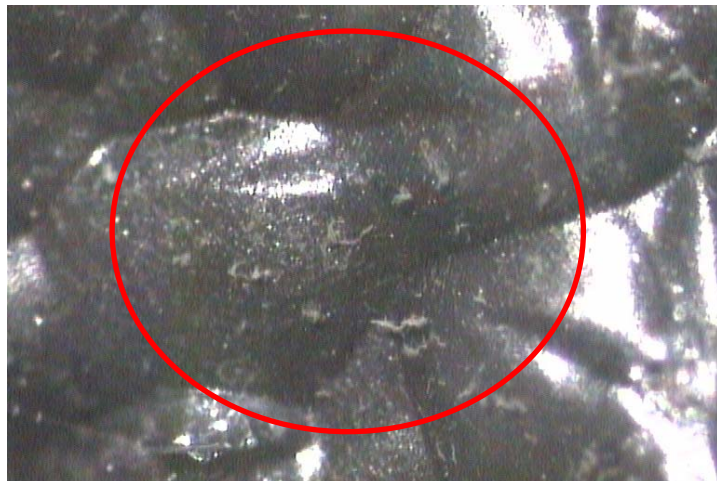
Foto 2: Untersuchungsmaterial HR ISO Rohrsystem nach einer Inkubationszeit von 28 Tagen mit Pilzwachstum (50fach vergrößert)
