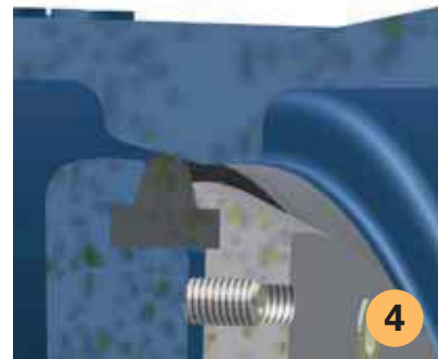
4 Endlose Dichtung im Abschluss aus belastbarem Elastomer in speziellem T-Profil über einteiligem Klemmring auf der Klappenscheibe befestigt. Exakte Vorspannung und Sicherung über Befestigungsschrauben und Konterstifte gewährleisten gesicherte Funktionsdichtheit.
